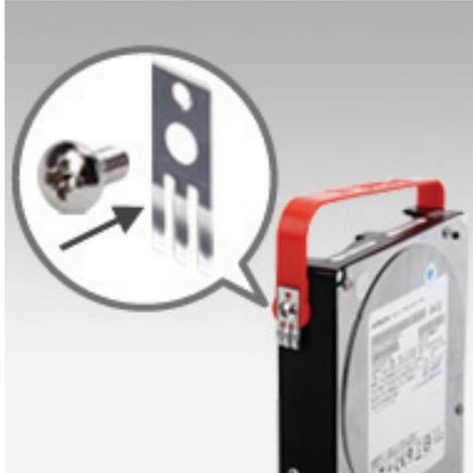
**Étape 3** - Fixez les supports du disque dur sur les côtés de vos disques dur à l'aide des vis jointes. Vérifiez que les supports sont alignés, la flèche pointant vers l'avant du ShareCenter, lors de l'insertion du disque dur.
