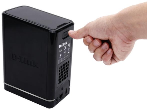
**Étape 1** - Retirez le panneau supérieur en appuyant fermement sur le loquet à l'arrière.
