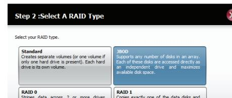
**JBOD** - permet de créer un grand disque virtuel en assemblant deux petits disques ou plus. Chaque disque dur composant un RAID JBOD peut avoir une taille différente et provenir d'un fabricant différent. La taille totale du RAID JBOD correspond au total combiné de tous les disques individuels de l'ensemble.
