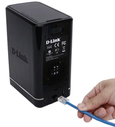
**Étape 6** - Connectez un câble Ethernet au port Ethernet. Ce câble doit relier le ShareCenter à votre réseau local, via un routeur ou un commutateur ou directement à un ordinateur pour sa configuration (câble croisé requis).
